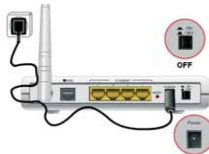
Figura 3.5 Conexión del router ADSL a la red eléctrica
