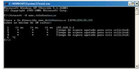
Figura 1.5 Resultado 'tracert' incorrecto: no se establecen conexiones con el exterior
