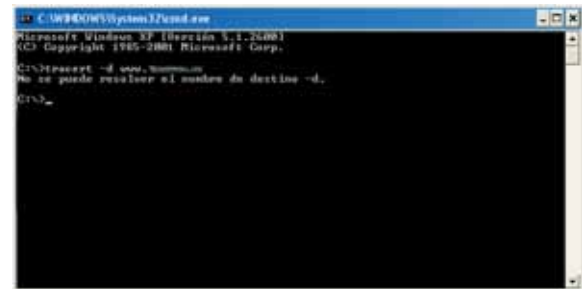
Figura 1.6 Resultado 'tracert' incorrecto: no se establecen conexiones con el exterior
